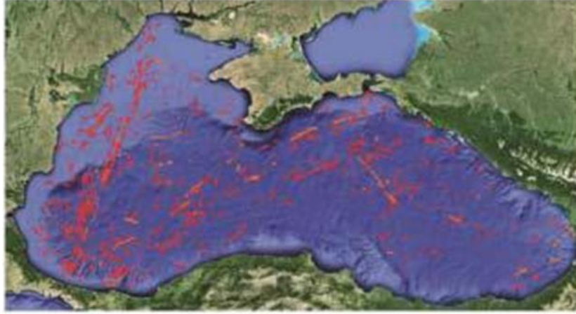
Şekil.15 2009-2011 Yılları Arasında Uydu Radar Verilerinin Analizi Sonucunda Tespit Edilebilen Karadeniz'e Gemi Yağlı Atık Boşaltım Haritası,.
